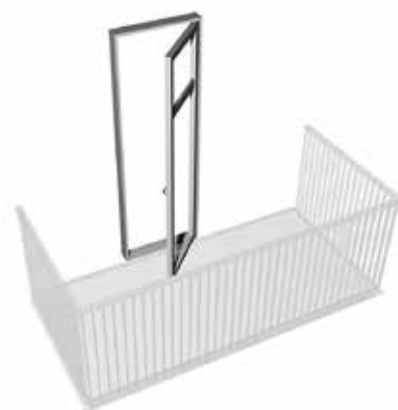
Enkeldörr med en dekorativ horisontell, utanpåliggande spröjs.
