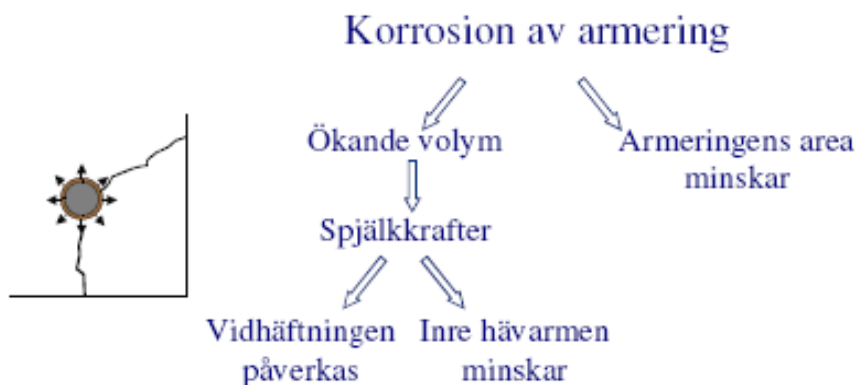
Figur B.1: Korrosion av armering och dess effekt på konstruktion
